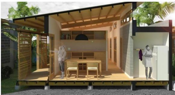
El corte constructivo de la casa ganadora del primer premio muestra su estructura mixta de madera y mampuestos.
