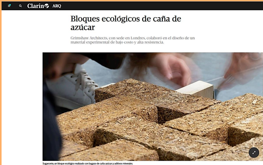
Sugarcrete, un bloque ecológico realizado con bagazo de caña azucar y aditivos minerales.
